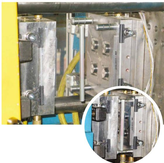
Die mould shields dienen zum Auffangen von Spritzgußteilen am Werkzeug.
