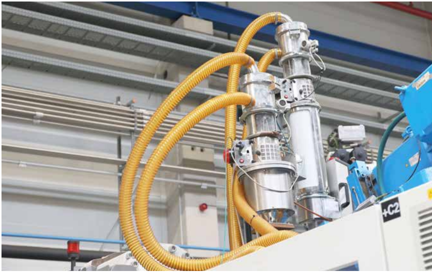
Staubabscheider von Wenz etwa direkt an der Spritzgießmaschine sorgen dafür, dass auch kleinste Verunreinigungen aus dem Granulat sicher ausgetragen werden.
