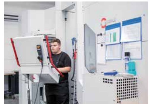
Mit dem neuen 5-Achs-CNC-Bearbeitungszentrum mit Roboter von Hermle ist die parallele Bearbeitung und Rüstung möglich.
