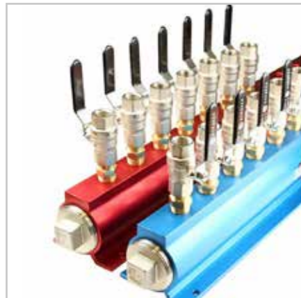
Aluminium-Wasserverteiler - Eingang 1 1/2" Anschluß 16-fach mit Kugelhähnen
